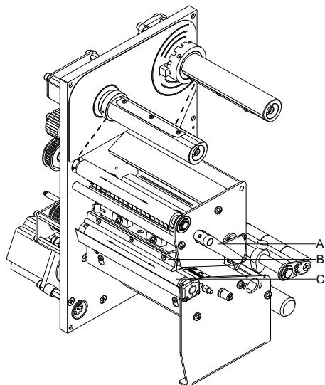
El ensuciamiento del rodillo de impresión puede repercutir en una mala calidad de impresión y además puede estropear el material de transporte.
