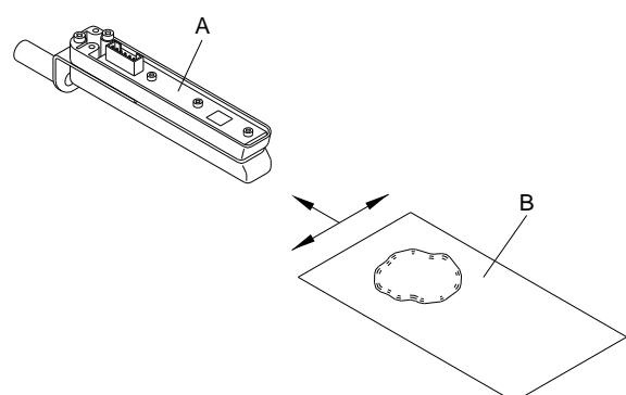
A célula fotoelétrica pode ficar suja com o pó do papel. Isto pode comprometer a deteção das etiquetas.
