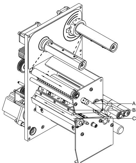
L'encrassement du rouleau de pression peut causer une mauvaise qualité d'impression et peut aussi entraver le transport des matériaux.
