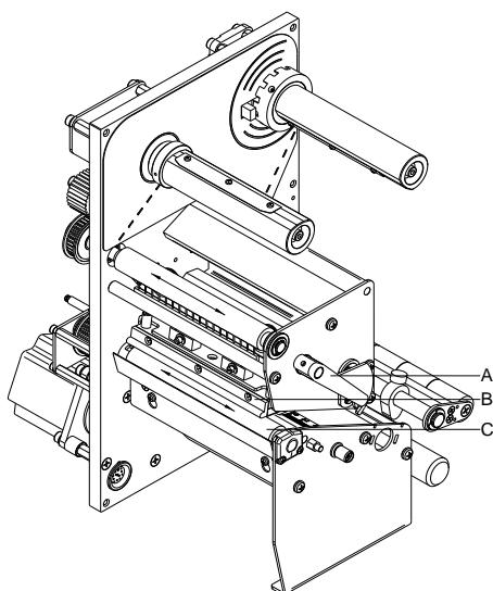
Baskı merdanesinin kirlenmesi, kötü bir baskı kalitesine ve malzeme taşımاسının sınırlanmasına neden olabilir.
