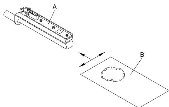
La fotocellula delle etichette può accumulare impurità a causa della polvere di carta. Questo può compromettere il riconoscimento della parte iniziale delle etichette.
