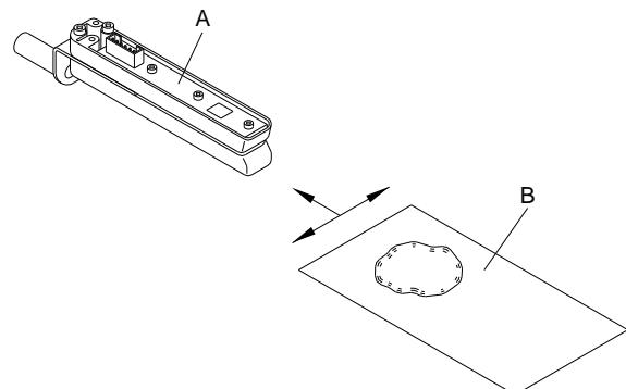
Die Etikettenlichtschranke kann durch Papierstaub verschmutzen. Dadurch kann die Etikettenabtastung beeinträchtigt werden.
