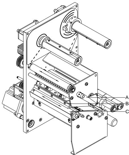
Eine Verschmutzung der Druckwalze führt zu einer schlechteren Druckqualität und kann außerdem zu Beeinträchtigungen des Materialtransports führen.
