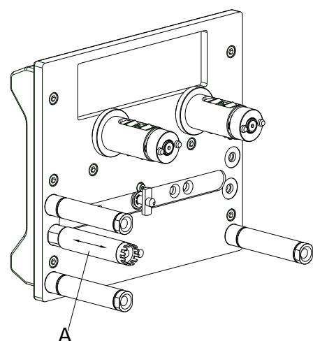
El ensuciamiento del rodillo de la cinta de transfer puede repercutir en una mala calidad de impresión y además puede estropear el material de transporte.
