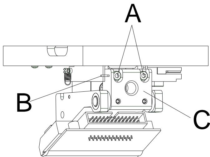
O ângulo de montagem da cabeça de impressão é geralmente de 26° em relação à área de impressão. As tolerâncias de produção da cabeça de impressão e do sistema mecânico podem, no entanto, tornar necessário um ângulo diferente.
