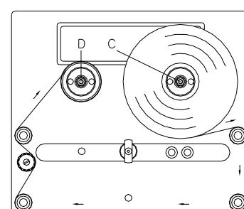
Şekil, solda bir baskı sistemi olduğunu gösterir. Sağdaki baskı sisteminde yeni makaranın sola ve kağıt çekirdeğin de sağa takılması gereklidir.
