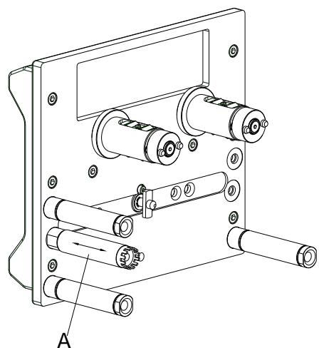
L'encrassement du rouleau de film transfert peut causer une mauvaise qualité d'impression et peut aussi entraver le transport des matériaux.
