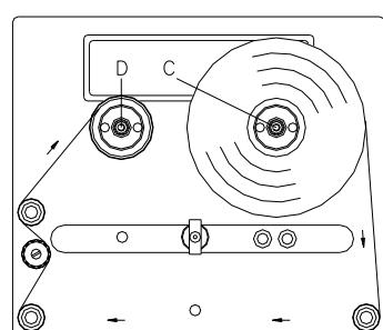
Le dessin dessus montre un système à gauche. Dans le cas où vous utilisez un système à droite, insérez le nouveau rouleau à gauche et le cœur de carton à droite.
