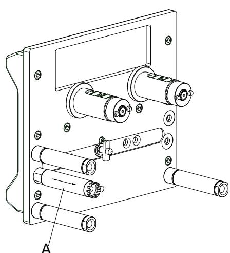
Makaranın kirlenmesi, kötü bir baskı kalitesine ve malzeme taşımاسının sınırlandırılmasına neden olabilir.
