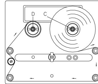
A ilustração apresenta um sistema de impressão do lado esquerdo. No caso de um sistema de impressão do lado direito, o novo rolo deverá ser colocado do lado esquerdo e o núcleo de cartão do lado direito.
