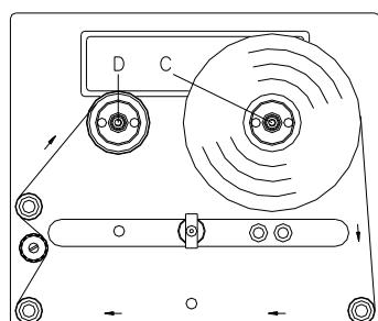
Die Abbildung zeigt ein linkes Drucksystem. Beim rechten Drucksystem ist die neue Rolle links und der Pappkern rechts aufzustecken.
