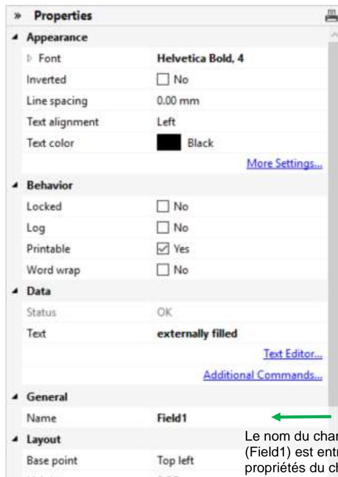
Pour les champs de texte, une police interne aux blocs d'impression directe doit être utilisée. Les polices internes aux blocs d'impression directe sont signalées par un symbole d'imprimante dans la liste.
