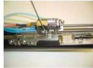
5. Tapez sur le bouton d'ajustement du jet. La gouttière se déplace automatiquement à la position de service-alignement.
