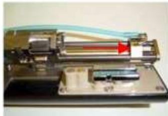
6. Tournez la tête du vis moletée et arrêtez jusqu'à au moment que le centre de boulon tourne sur 90 ° et le réglage de la buse soit libéré.
