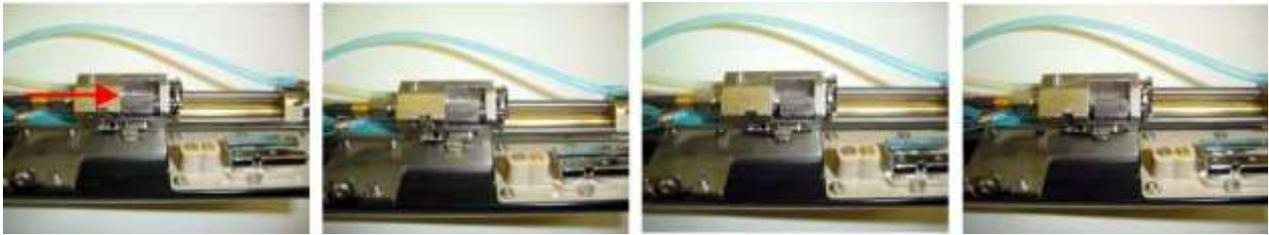
10. Fermez la buse complètement en appuyant sur le bouton fléché vers la gauche. Tapez plusieurs reprises avec succession rapide sur / off / on. Appuyez sur "Réglage de Jet " et attendre que la jointe de la buse soie ouvert. Vérifiez la position de jet dans le tube de gouttière
