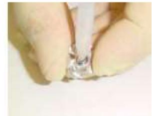
8. Soufflez en bas de la buse avec air propre à une pression parmi 2 - 6 bar. Concentrez le pistolet à air exactement au milieu de la buse et souffler pendant plusieurs secondes. Tout d'abord contre la sortie de la buse et ensuite contre elle.
